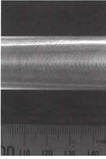
Fig. 2 接合部表面外観例 (A6N01S-T5, 8mm 材)
