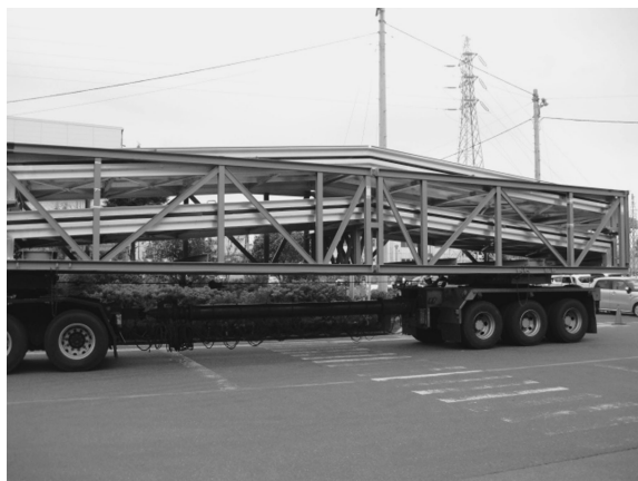
出荷を待つ、浄水場向けの上覆蓋（長さ13.5 m×幅2.9 m）
