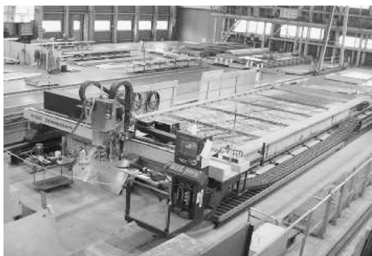
板切断で活躍する CNC プラズマ切断機
