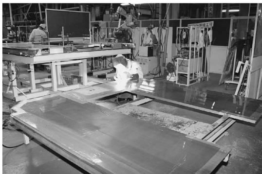
Fig. 2 アルミ車輛の内装パネル製作工程でTIG溶接を適用
