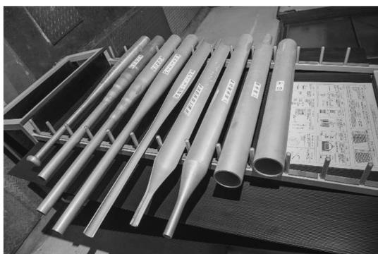
写真9 バット成型工程（恵那工場）
