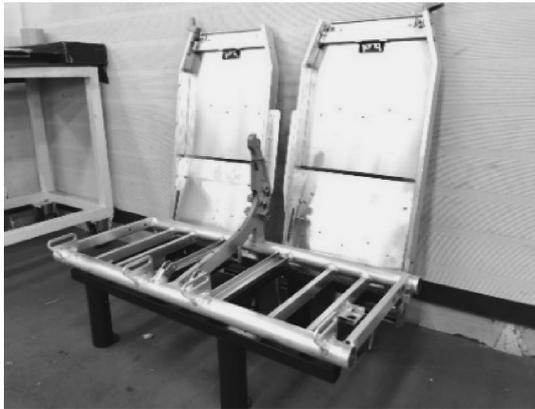
写真14 鉄道用シートフレーム（大阪工場）
