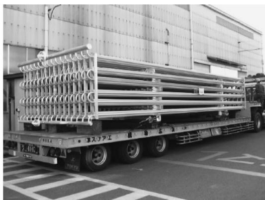
写真11 LNG気化器（滋賀工場）
