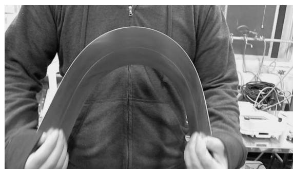
図11 狭窄ノズルを用いたティグ溶接法による厚さ0.3 mmのアルミニウム合金の突合せ溶接例
