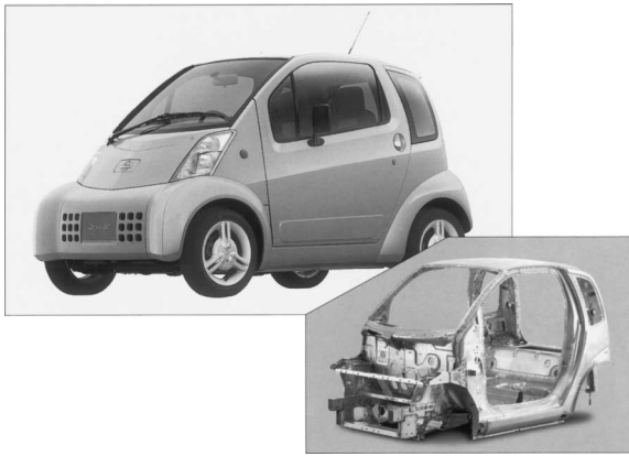
Fig. 3 オールアルミニウム製自動車「ハイパーミニ」電気自動車（モノコック方式）
