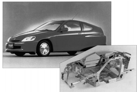
Fig. 2 オールアルミニウム製自動車「インサイト」ハイブリッド車（スペースフレーム式とモノコック方式との混合）
