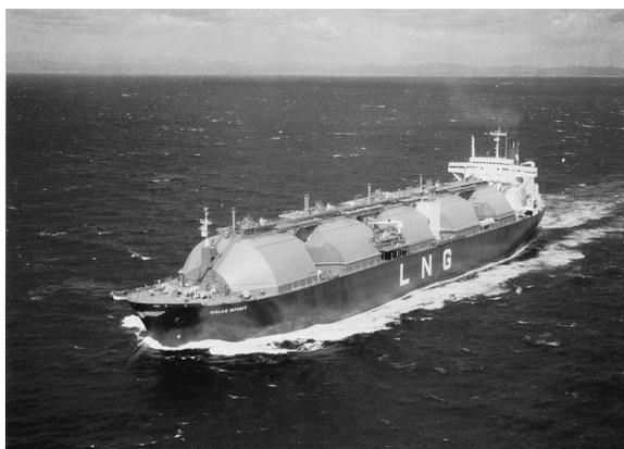
Fig. 3 LNGタンカー（MOSS型球形タンク）
