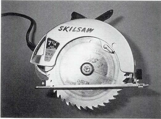
Fig. 39 切断用丸鋸
