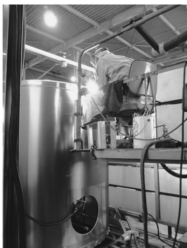
Fig. 2 移動販売用軽トラック等の荷台に搭載される円筒状のアルミ製灯油タンクを溶接
