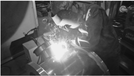
アルミニウムタンクのMIG溶接作業②
