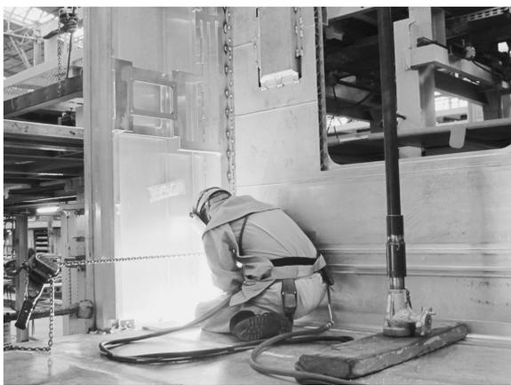
Fig. 2 構体内側を溶接
