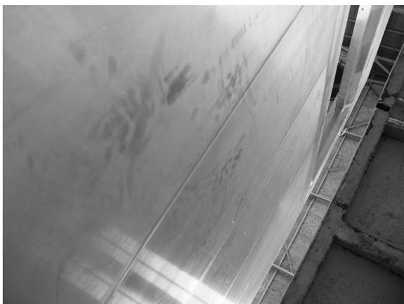
Fig. 3 FSW システムによる側構体の接合面
