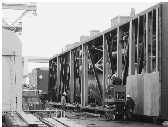
Fig. 2 海外への出荷を待つ空気分離装置
