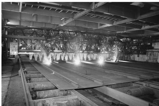
写真1 16電極溶接装置でロンジのすみ肉溶接を行う
