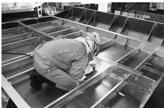
写真3 舟艇工場ではほぼ全ての溶接作業をMIG溶接で施工
