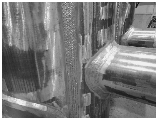
美しいビード外観。溶接パス数が多いため、迅速かつ慎重な溶接作業が求められる。
