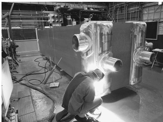
熱交換器コアと板厚19 mm のヘッダータンクのアルミ溶接の様相。
