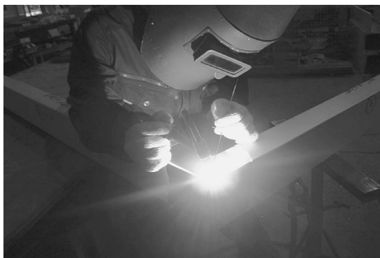
適切な電流及びトーチスピード・角度の管理の下、板厚2mmの玄関庇をTIG溶接するもよう
