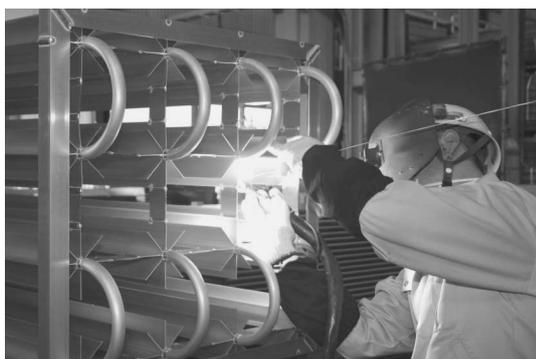
Fig. 2 優れた溶接技能者が熱交換器の部材をTIG溶接
