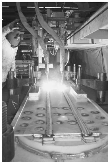
Fig. 1 アルミ車両の部材をツイントーチ搭載の専用自動溶接装置でMIG溶接
