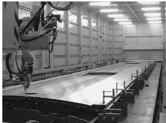
Fig. 1 レーザ&ミグアーク・ハイブリッド溶接による車体製作
